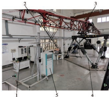
图 4 大型喷杆悬架半实物仿真平台
