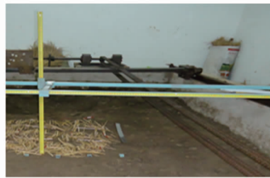
图2 秸秆示踪器和秸秆位移测量装置
